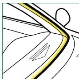
2. Direktverglasung mit äußerer Klebung
