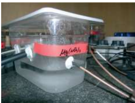
Bild 1: Klimakammer mit Salzlösung und Sensoren
