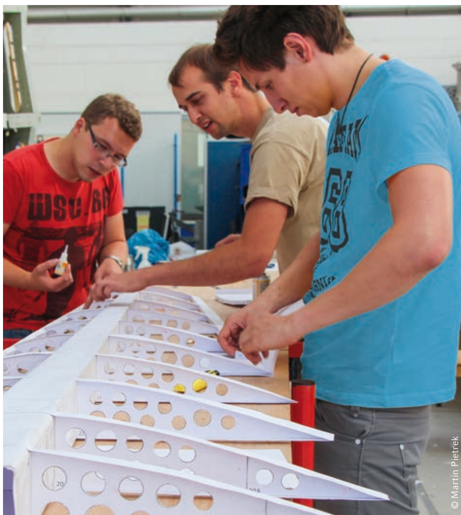
Die Spannweite der Tragflächen beträgt 18,21 Meter. Auch hier kamen nur Papier und Klebstoff zum Einsatz.
