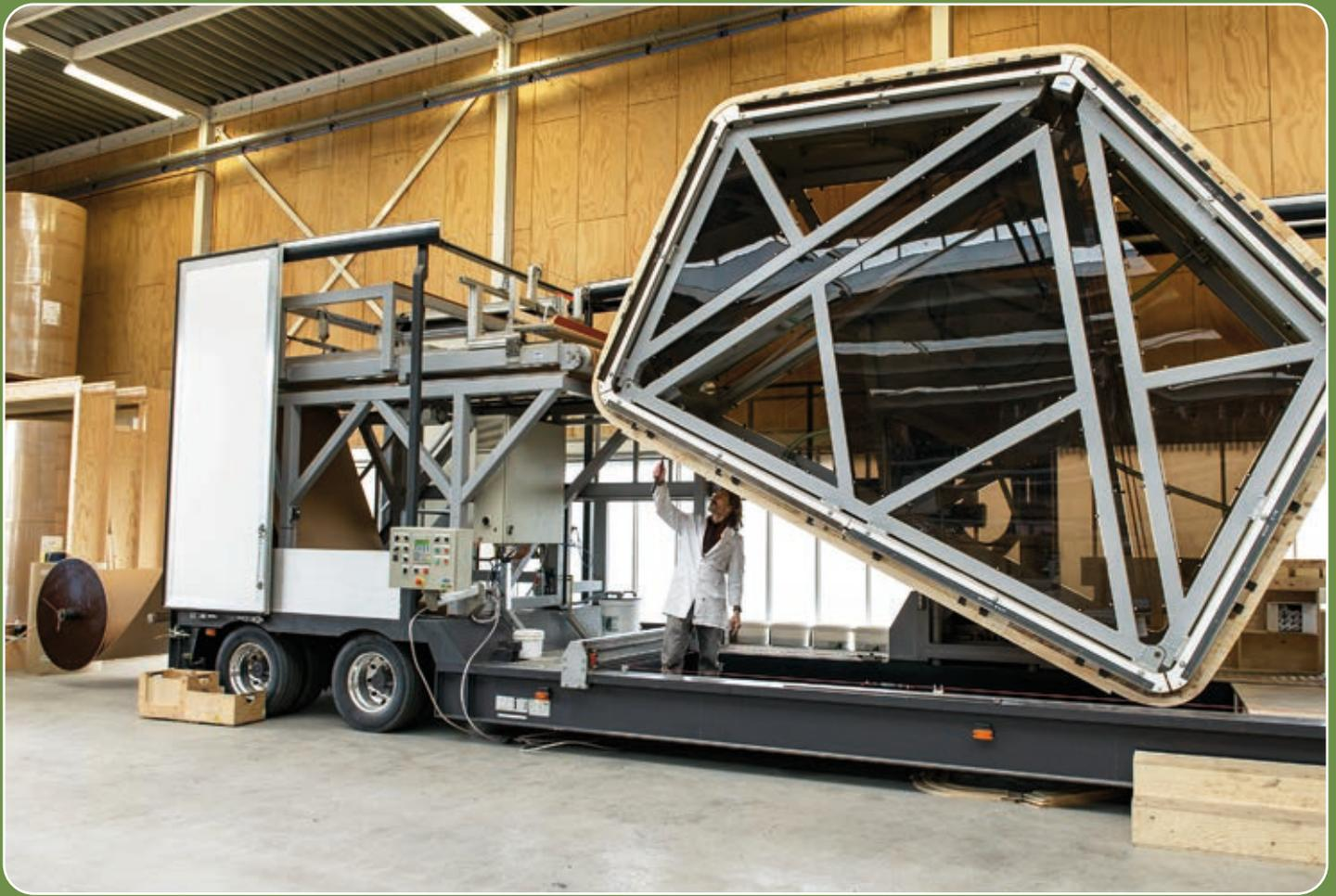
*Mit der patentierten einzigartigen Wickelmaschine werden die 24 Lagen in „Hausform“ gewickelt.*
