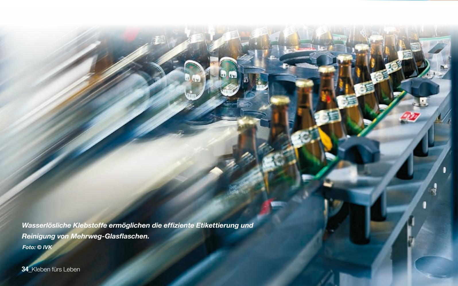
*Wasserlösliche Klebstoffe ermöglichen die effiziente Etikettierung und Reinigung von Mehrweg-Glasflaschen.*
