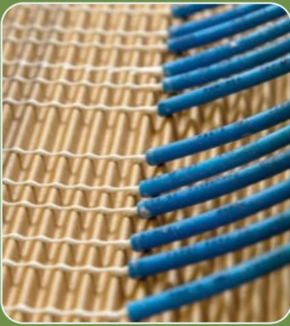
*Mit einer eigens entwickelten Technik wird der Klebstoff auf die Wellpappe aufgetragen.*
