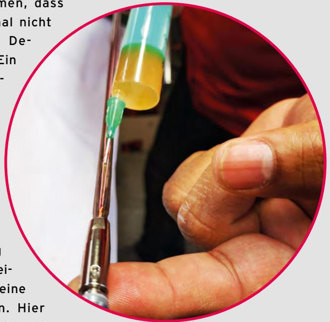
verbunden. Dadurch wird die Verbindung des Stoffs mit dem Gitter unterstützt und ein dichter Abschluss gewährleistet. Auf der Innenseite wird zudem eine Polsterung an das Maskengitter geklebt, die für einen sicheren Halt beim Tragen sorgt. Der transparente Klebstoff hinterlässt keine Rückstände auf dem Stoff, ist schlagfest und anpassungsfähig.
