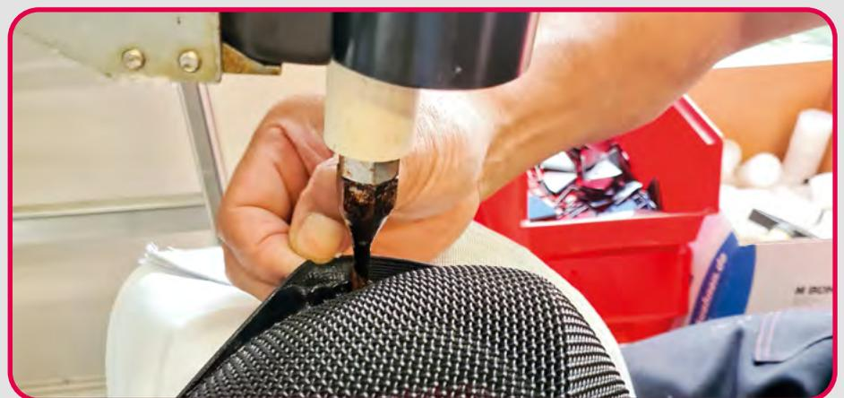
**Der textile Latz der Fechtmaske wird mittels eines Schmelzklebstoffs mit dem Maskenschutzgitter verbunden.**
