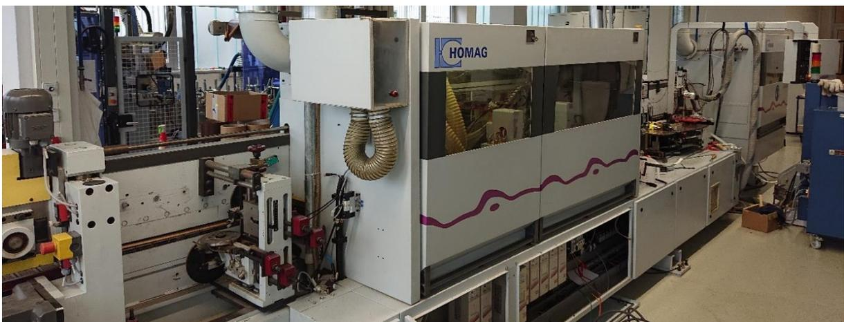
Abbildung 4-17 Kantenfräsanlage
