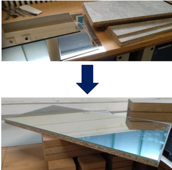
Abbildung 4-19 Substrate und Spiegel- und Plattenverbund
