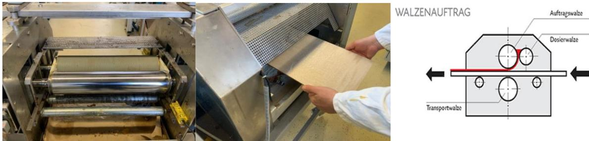
Abbildung 4-11 Dispersionsauftrag
