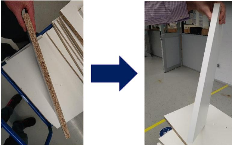
Abbildung 4-16 Spanplatte-Platte vor und nach dem Kantenleimprozess
