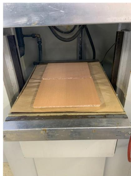
Abbildung 4-13 Fügen mit Flachpresse
