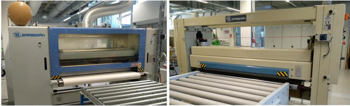
Abbildung 4-21 Flatlaminationsanlage (links) und Flachpresse (rechts)
