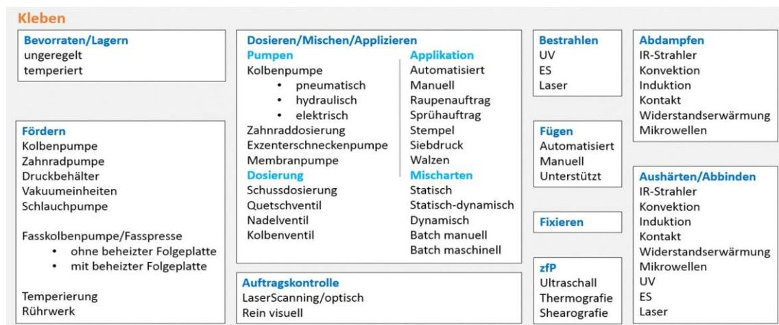
Abbildung 3-8: Prozessschritte und Prozessmodule des Klebens
