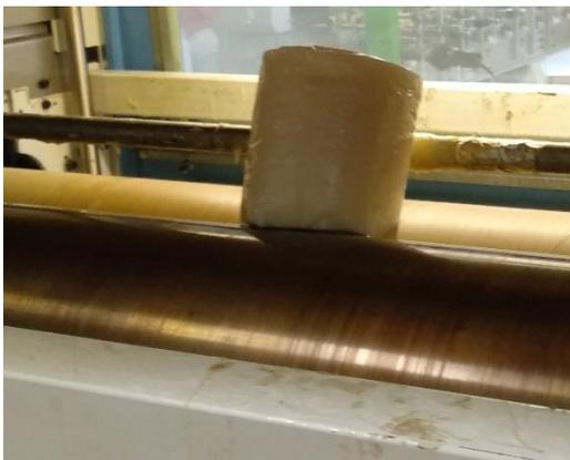
Abbildung 4-20 Aufschmelzen der Polyurethankerze
