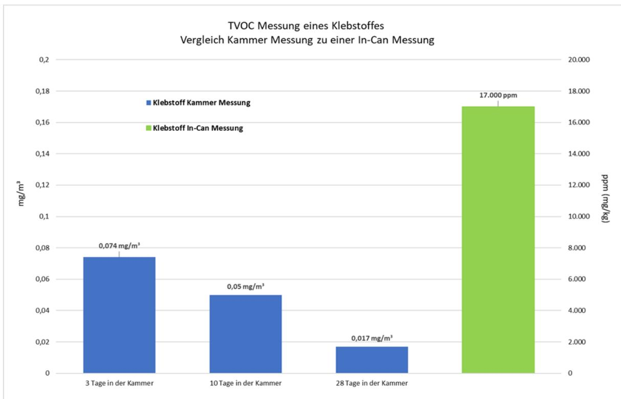
In-can-Messwerte werden in dieser Grafik in ppm (mg/kg) und Kammer-Messwerte in mg/m<sup>3</sup> angeben. Nicht nur deswegen sind die Werte deutlich unterschiedlich, sie sind auch nicht ineinander umrechenbar. Den größten Anteil am TVOC macht hier das Filmbildehilfsmittel aus, welches zu ca. 2 % im Klebstoff vertreten ist.
