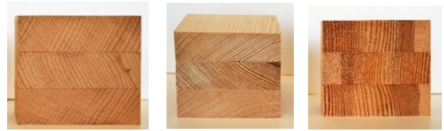
Abb. 4: Beispiele für eine sachgemäße Klebung von Hölzern
