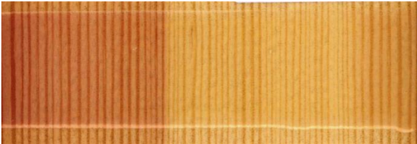
Abb. 3: Verfärbung auf Kiefer
