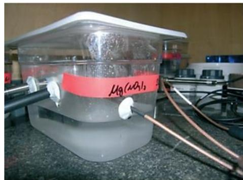
**Bild 1: Klimakammer mit Salzlösung und Sensoren**
