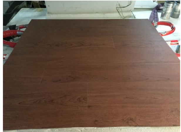
Testsystem Designbelag im Prüfstand (geklebt)
