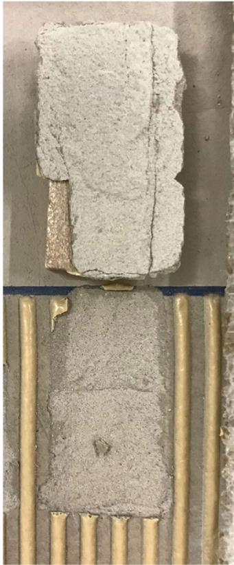
Kohäsiver Bruch innerhalb der Spachtelmasse bei  $> 1,5 \text{ N/mm}^2$
