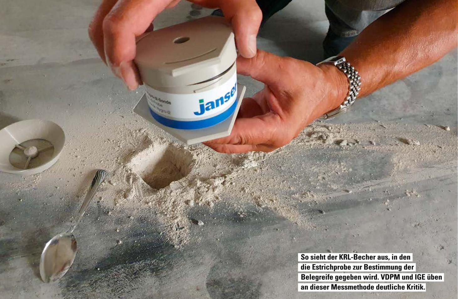
So sieht der KRL-Becher aus, in den die Estrichprobe zur Bestimmung der Belegreife gegeben wird. VDPM und IGE üben an dieser Messmethode deutliche Kritik.
