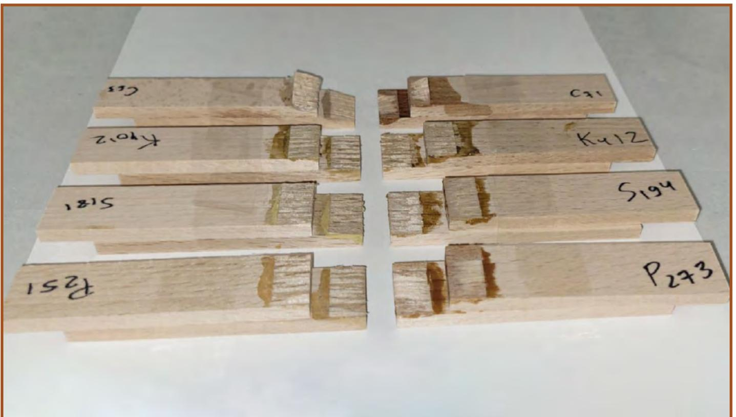
Mit federbasiertem Klebstoff geklebte Prüfkörper aus Holz nach der mechanischen Prüfung. Der Holzaustriss zeigt, dass der Klebstoff stärker ist als das Holz.
