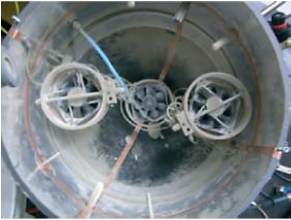
Bild 3: Blick in die geöffnete Bestäubungskammer mit eingeführten Sensoren
