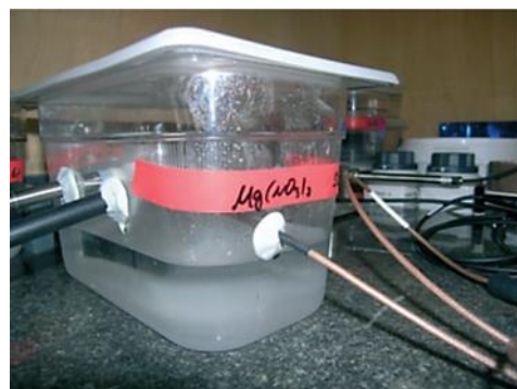
Bild 1: Klimakammer mit Salzlösung und Sensoren
