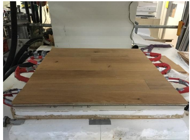
Testsystem Mehrschichtparkett im Prüfstand (schwimmend)
